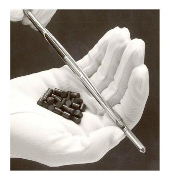
Dissolution yields:  $UO_2$  powder:40-100%<sup>1</sup>  $UO_2$  pellet: 15 %<sup>2</sup> SIMFUEL pellet: 0.2 %<sup>2</sup>
